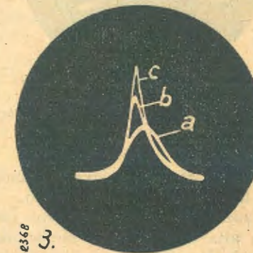
Fig. 3 — a) Oscillogramma della curva di selettività di uno studio amplificatore con circuiti semplici. Cag è normale. b) Per un aumento di Cag la curva diventa asimmetrica. c) Cag è ancora aumentata fino a 0,008 pF.
